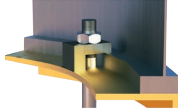
Silo Ankraj Montajı
