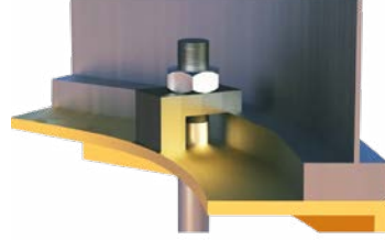
Silo Ankraj Montajı
