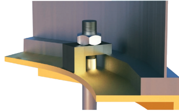
Silo Ankraj Montajı
