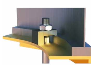
Silo Ankraj Montajı
