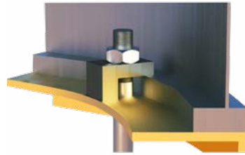
Silo Ankrāj Montajı
